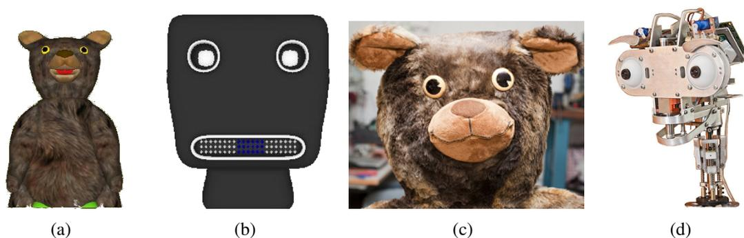
Figura 7.10: Bocas utilizadas en el estudio comparativo de la Sección 7.4.3.2; a) Modelo animado del Robot Ursus; b) Modelo animado de un robot con una boca basada en LEDs; c) Robot Ursus; y d) Cabeza robótica Muecas. (Figuras obtenidas parcialmente de la publicación [Cid et al., 2012])
